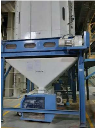
Gambar 9. Permukaan mesin (mixer horisontal) halus dan rata
